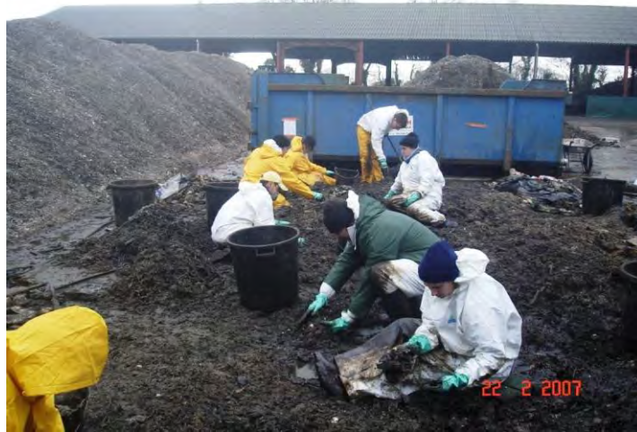
Tri de déchets avant le prétraitement (nécessaire en cas d'absence de tri durant la collecte) (Source : Le Floch Depollution)
